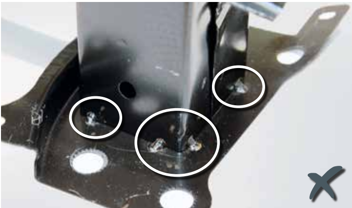
Iba bodové zvary namiesto súvislého zvaru. Tu na príklade výrobcu I.S.A.M. S.p.A., Taliansko.
