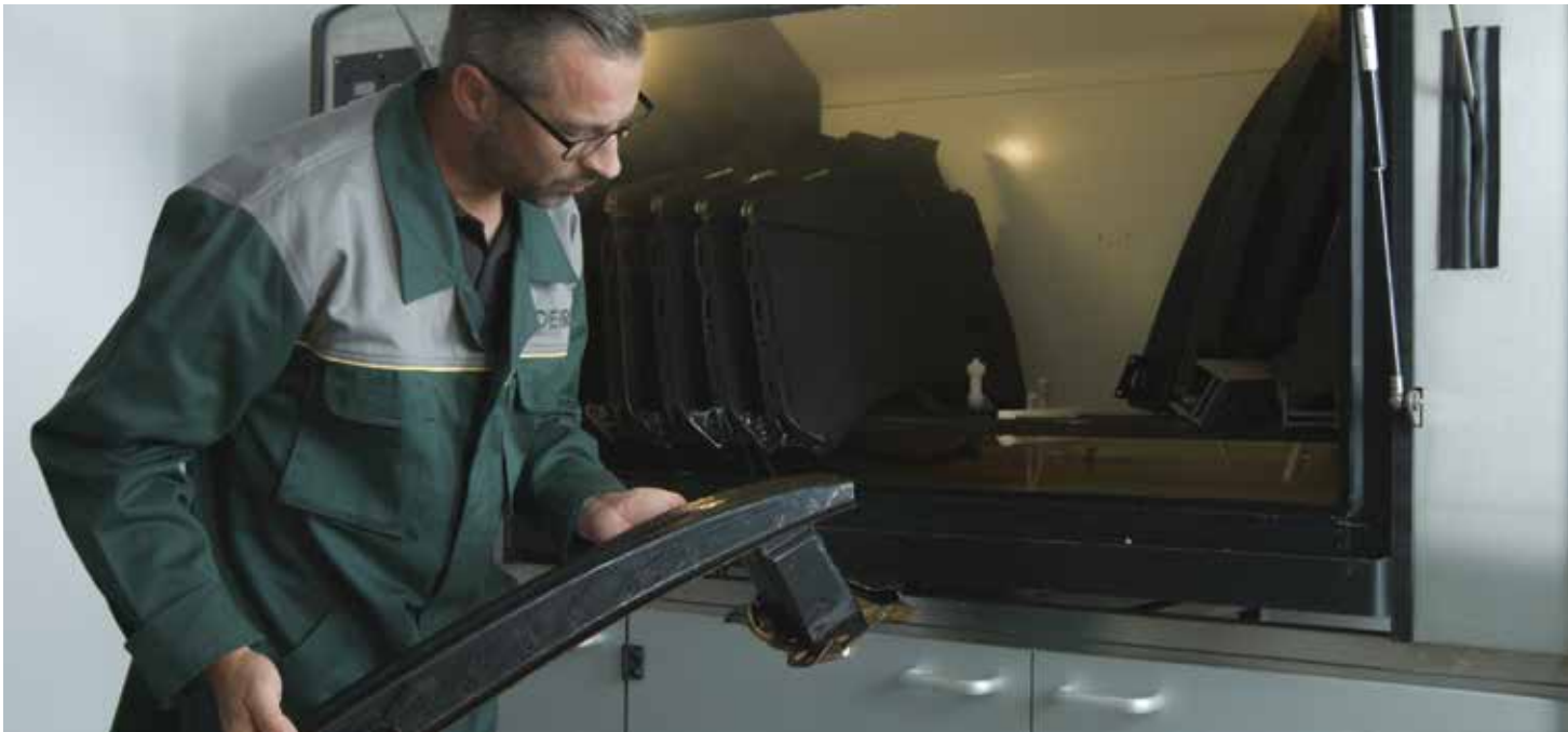
Hodnotenie protikorózneho ochrany na základe skúšky soľnou hmlou
