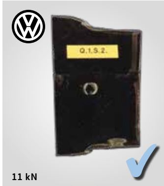
Bodový zvar Originálneho dielu Volkswagen: pri odbornom zváraní nie je nijaké oddelenie v zware.
