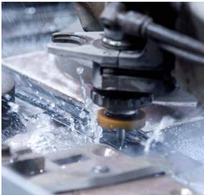
Vyrezávanie vzoriek vodným lúčom
