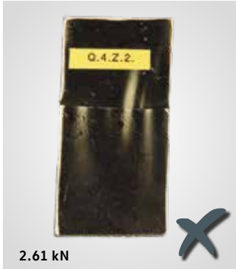
Bodový zvar konkurenta YP, Taiwan: už pri pôsobení sily 2,6 kN sa ukázalo oddelenie v zware.
