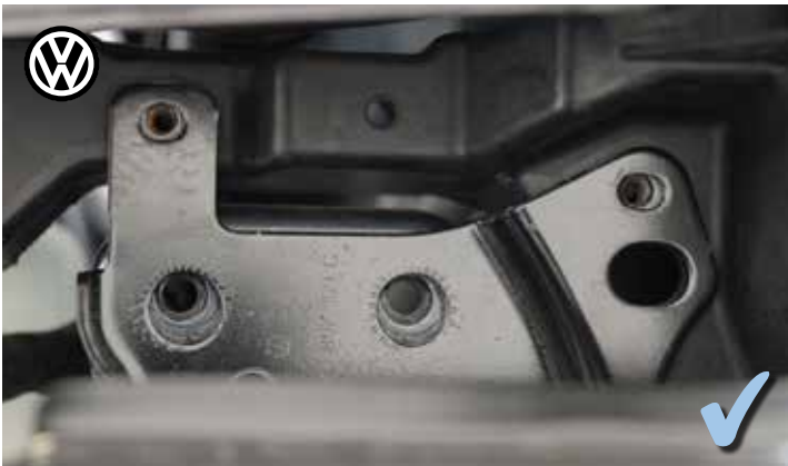
Prekrývajúci sa obrazec otvorov pri Originálnej výstuhe predného nárazníka Volkswagen.
