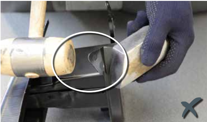
Oprava skrivených upevňovacích otvorov pre skrutky. Tu na príklade výrobcu I.S.A.M. S.p.A., Taliansko.
