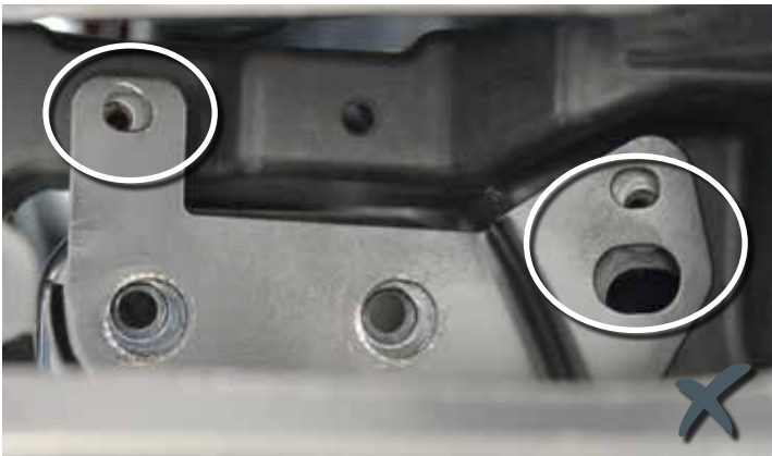
Nekrýjúci sa obrazec otvorov. Montáž možná iba po úpravách. Tu na príklade výrobcu I.S.A.M. S.p.A., Taliansko.
