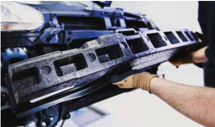
Montáž výstuhy predného nárazníka s namontovanou absorpčnou penou
