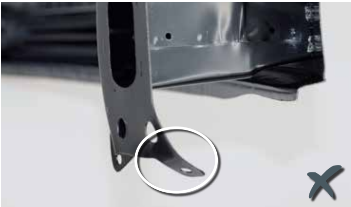
Pokrivené upevňovacie otvory pre skrutky boli viditeľné už pri prvotnej vizuálnej kontrole. Tu na príklade výrobcu YP, Taiwan.
