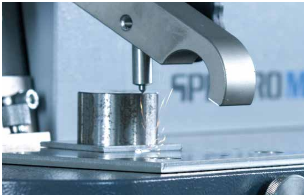
Určenie zloženia materiálu spektrometrom
