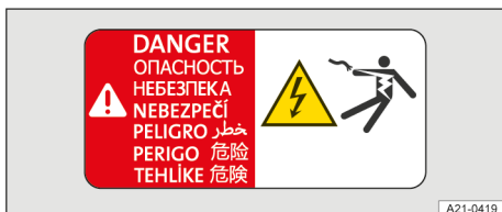
Obr. 4 Výstražný štítok na vysokonapäťových komponentoch.
