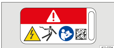
Obr. 5 Výstražný štítok na vysokonapäťových komponentoch.
