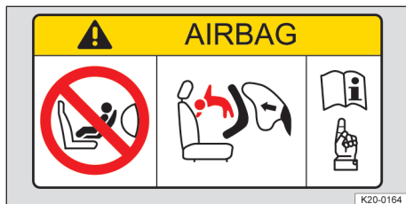
Obr. 1 Nálepka airbag na slnečnej clone (principiálne zobrazenie).
