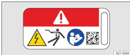
Obr. 4 Výstražný štítok na vysokonapätových komponentoch.
