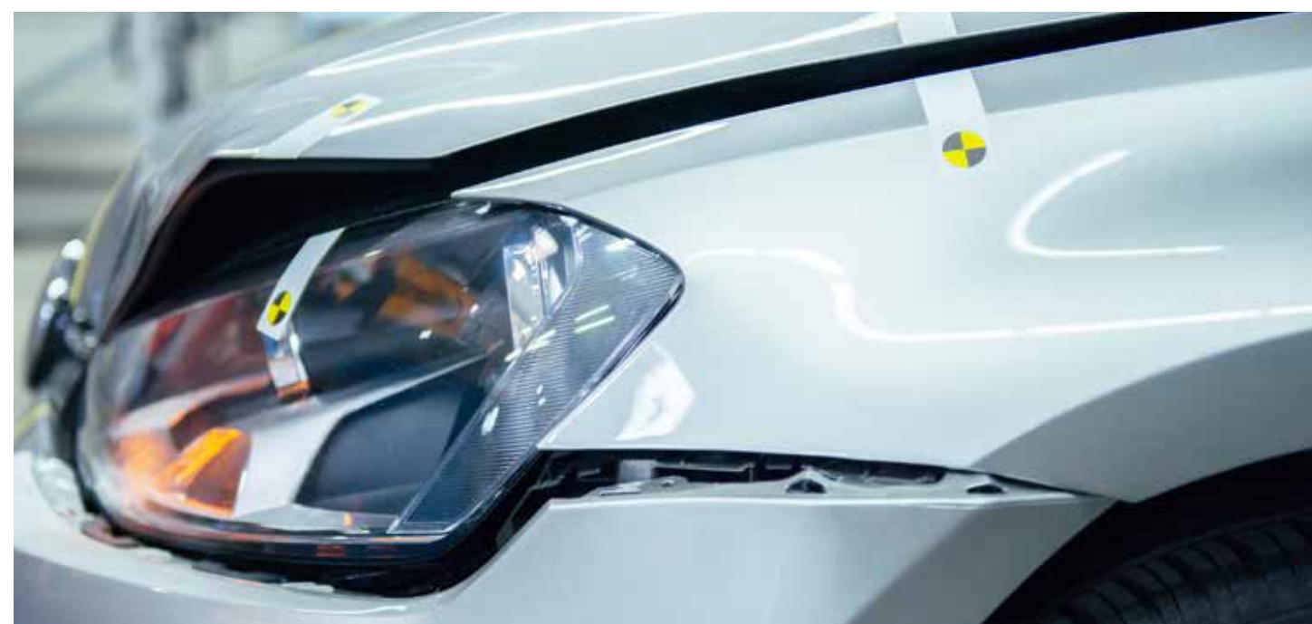
Golf VII s dielmi IAM. Deformácie po crash teste.
