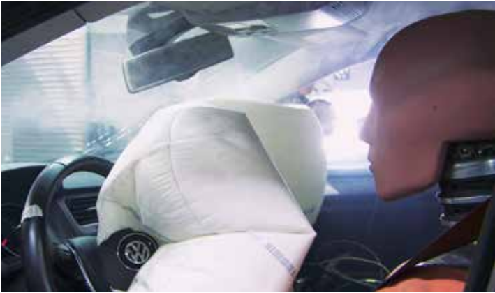
Interiér Golf VII s dielmi IAM po crash teste. Airbag aktivovaný.
