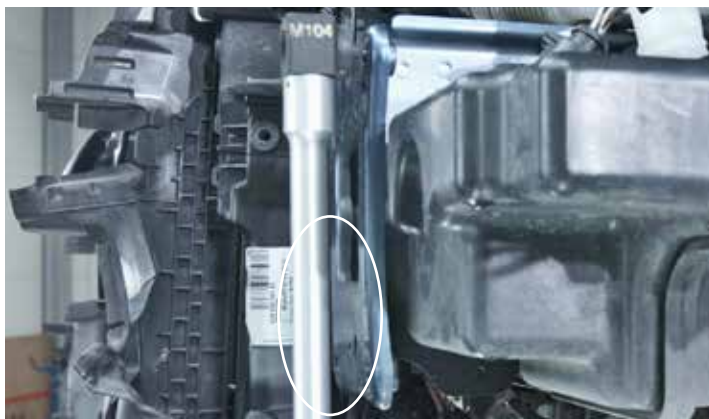
Golf VII s Originálnymi dielmi. Príruba po crash teste: nie je potrebné nijaké vyrovňovanie.
