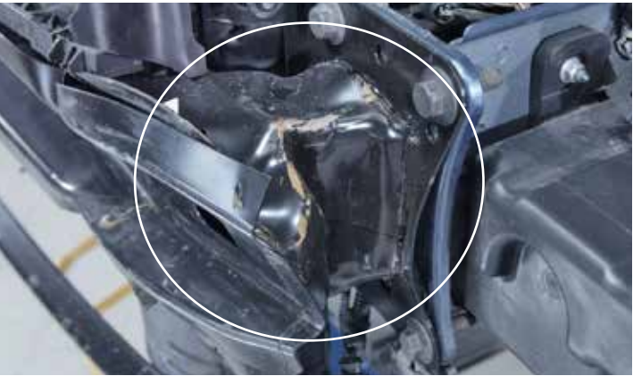
Golf VII s Originálnymi dielmi. Crash box po náraze stlačený o 37 mm.
