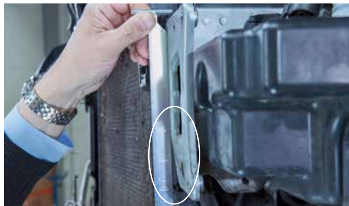
Golf VII s dielmi IAM. Príruba po crash teste: vyrovňovanie je potrebné.
