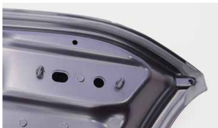
Originálna kapota motora Volkswagen s utesnením falcu.
